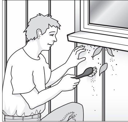
Kontrollér, at ventilationsåbninger under vinduernes sålbænke ikke er tilstoppet.
